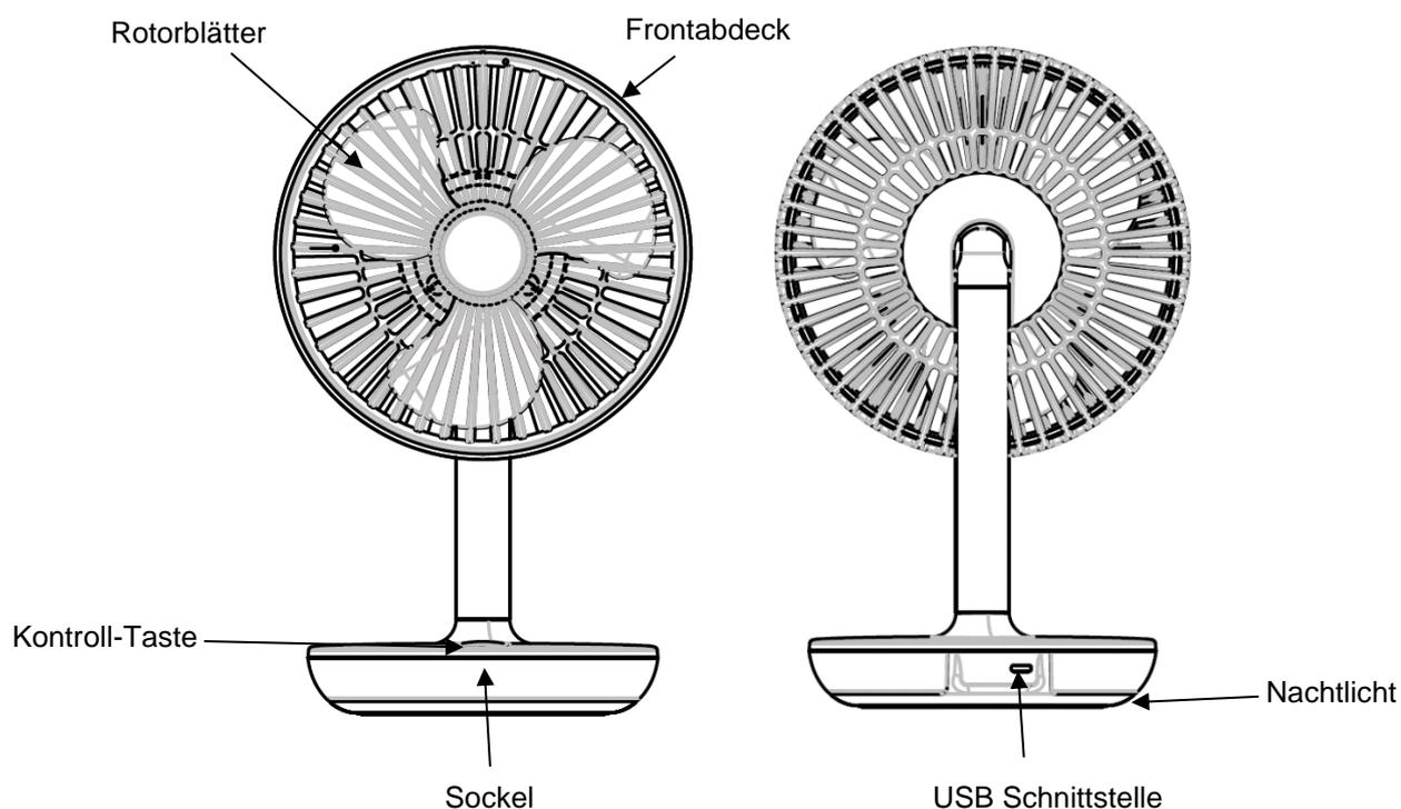
*Dieses Produkt wird mit einem 1,2 m langem USB-Ladekabel (Typ C) geliefert. Wir empfehlen die Benutzung eines 5V/1A oder 5V/2A Ladegeräts.*
